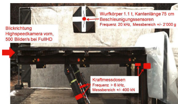
Vue latérale de l'installation d'essai avec sa technique de mesure.
