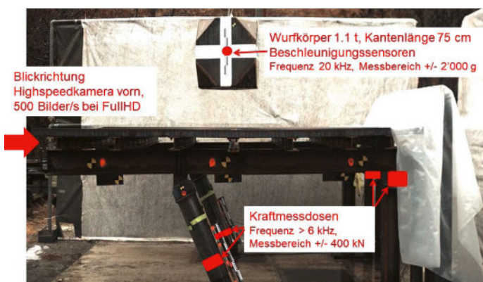
Seitenansicht Versuchsaufbau und Messtechnik für vertikale Fallversuche.
