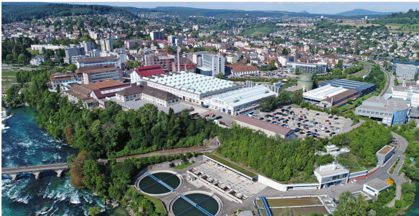
Weite Teile der Gemeinde Neuhausen werden mit Abwärme aus der Abwasserreinigungsanlage Röti (im Vordergrund), die im Kesselhaus auf dem Industriegebiet (im Hintergrund) erhitzt wird, versorgt.
