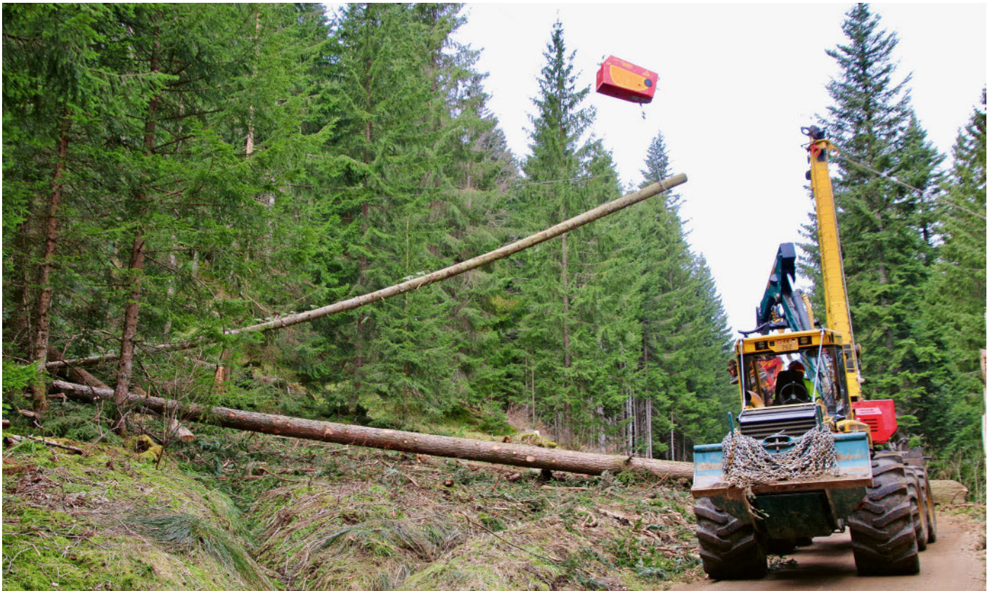
Am Seilkran kommen die geschlagenen Bäume den Hang hinunter zur Forststrasse, wo sie weiterverarbeitet werden.
